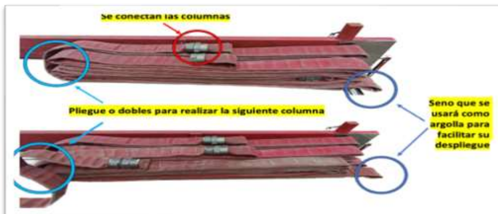
Figura 14. Elaboración de las demás columnas. 30
