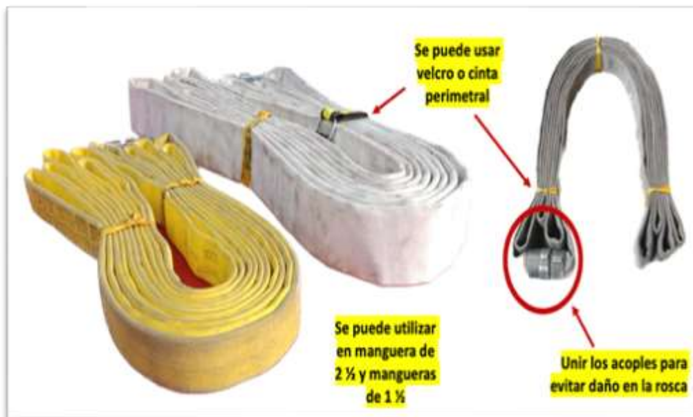
Figura 145. Paquete de mangueras en "U" o herradura. 43
