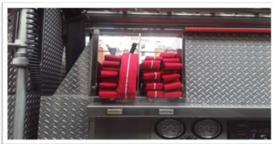
Figura 119. Tendidos de manguera en líneas pre conectadas. 36
