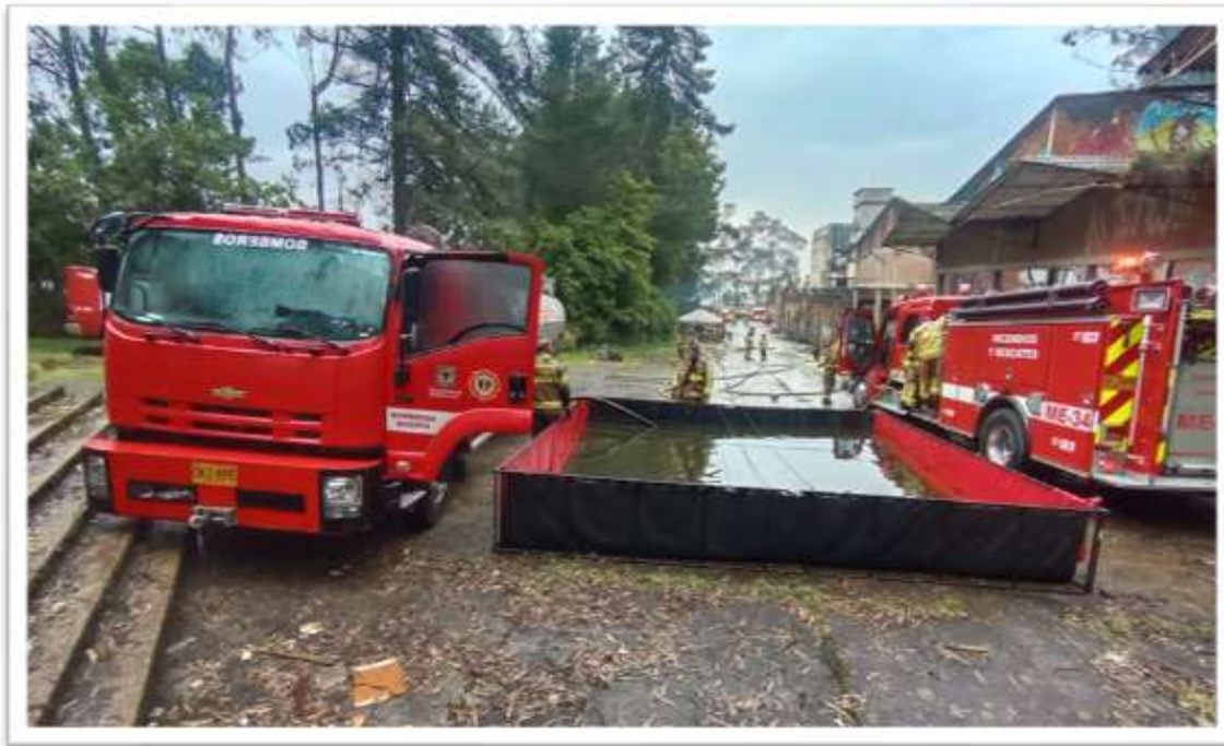
Figura 6. Transvase de agua utilizando bombeo con depósitos de agua portátil. 21
