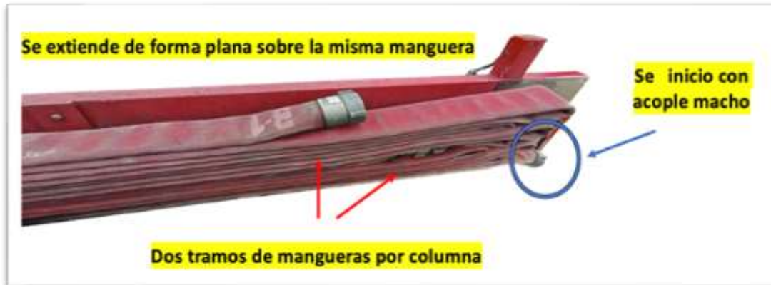
Figura 13. Elaboración primera columna cama de mangueras. 29
