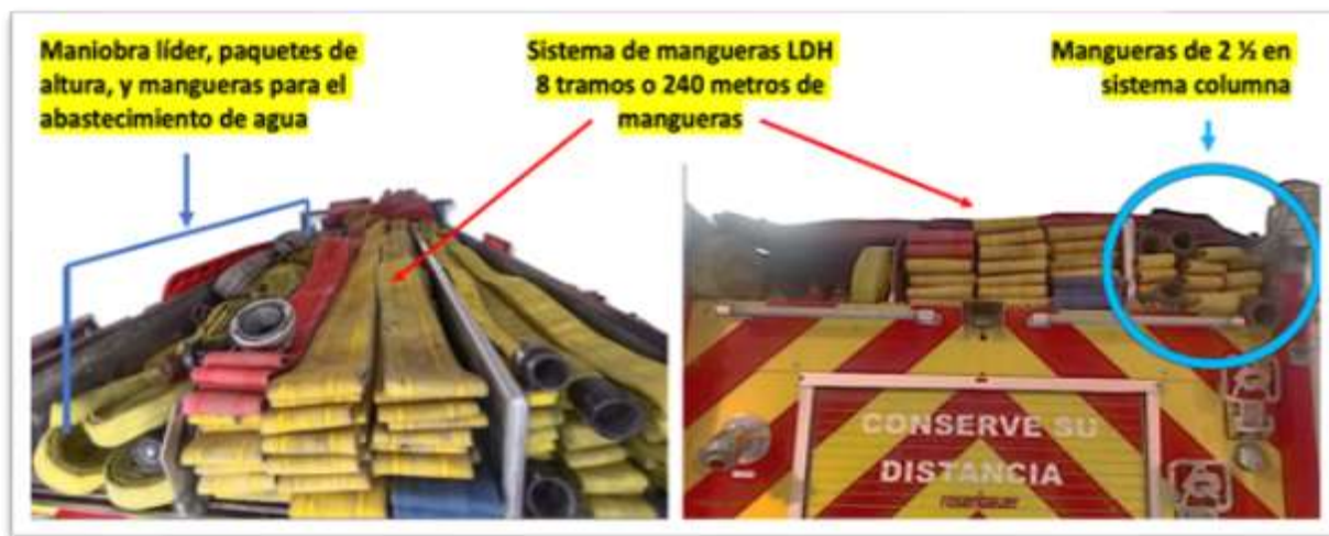
Figura 97. Disposición de cama de mangueras con sistema de aseguramiento de agua para grandes caudales LDH. 33
