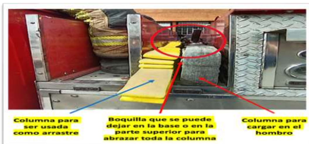
Figura 22.12. Disposición de pre-conectada acomodo en columnas. 39
