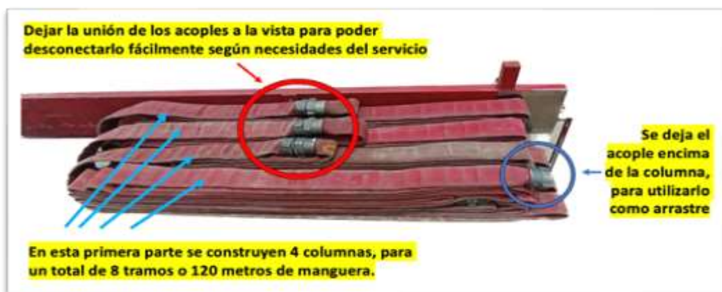
Figura 75. Primera sección de la cama de mangueras tipo columna. 31
