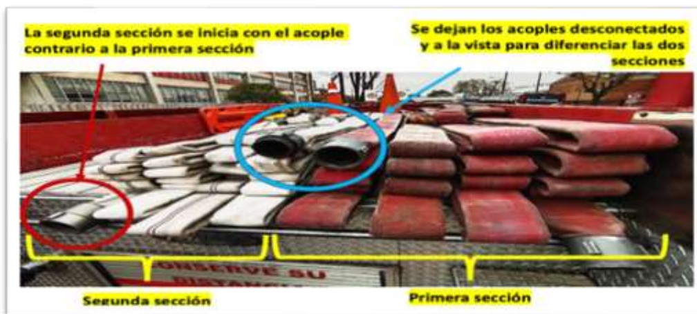
Figura 86. Especificaciones tendido de mangueras tipo columnas. 32
