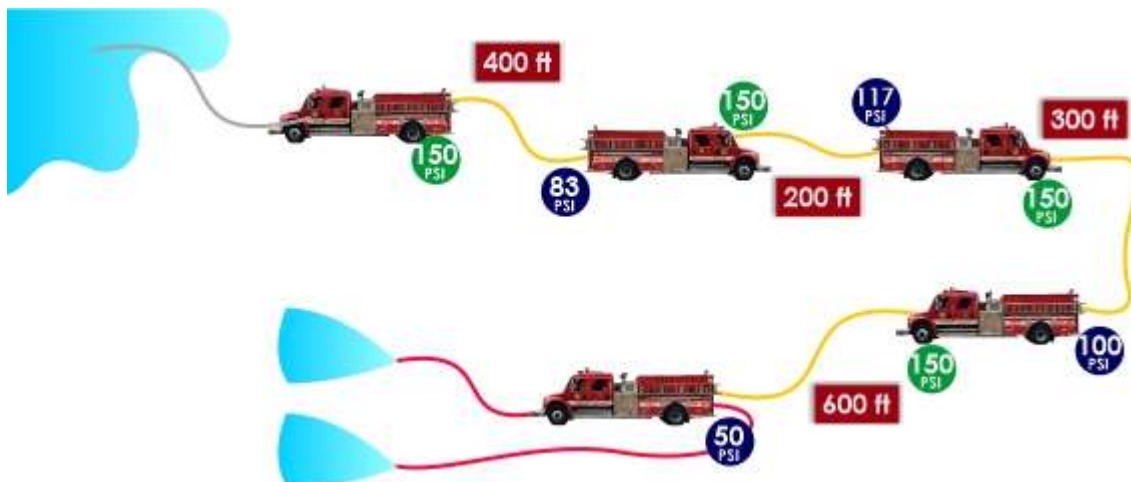
Figura 4. Bombeo en serie. 19
