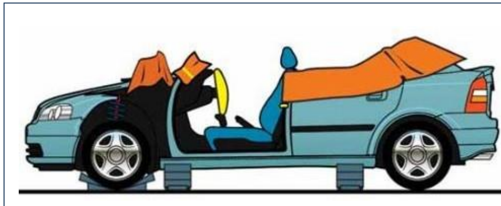
Ilustración 68 RETIRADA TOTAL DEL TECHO
