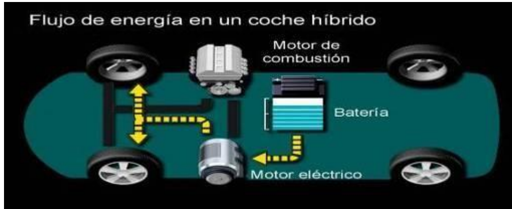
Ilustración 46 FLUJO DE ENERGÍA EN HÍBRIDOS / ELÉCTRICOS
