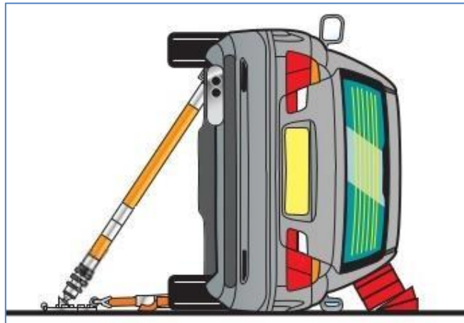
Ilustración 63 ESTABILIZACIÓN VEHÍCULO EN POSICIÓN LATERAL.
