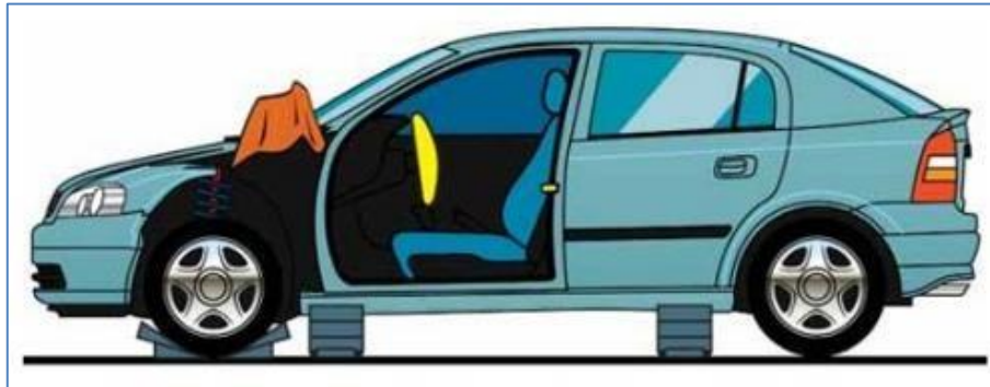
Ilustración 65 Retirada de la Puerta de un vehículo sobre sus ruedas
