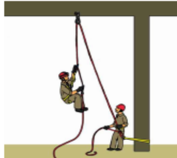
Ilustración 159 SISTEMA PRACTICA DE ASCENSO
