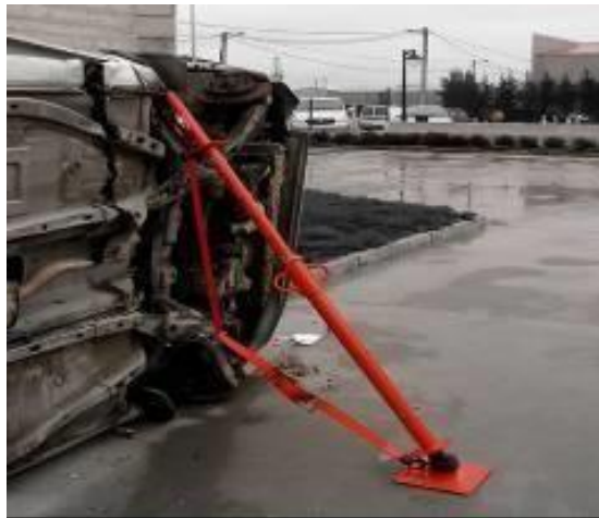
Ilustración 37 Riostras de Apuntalamiento
