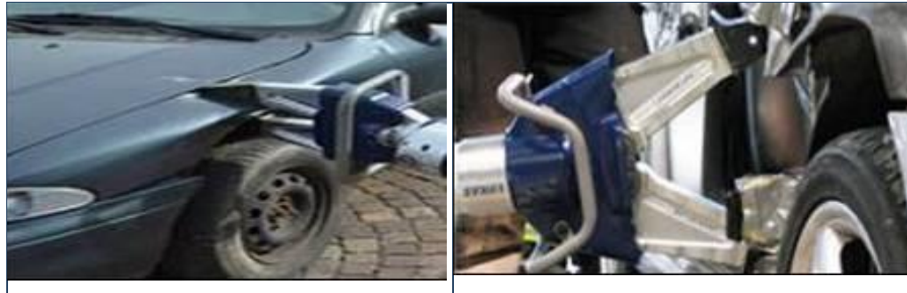
Ilustración 32 Uso del separador Hidráulico
