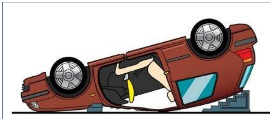
Ilustración 66 RETIRADA DE LA PUERTA DE UN VEHÍCULO SOBRE EL TECHO
