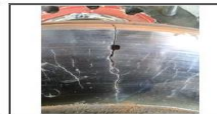
FRACTURA DISCOS DE FRENO POSICION 2
