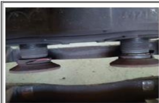
DESPLAZAMIENTO NO UNIFORME EN PISTONES DE MORDAZA
