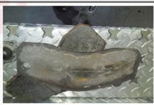
DESGASTE EXCESIVO Y PREMATURO DE PASTILLAS
