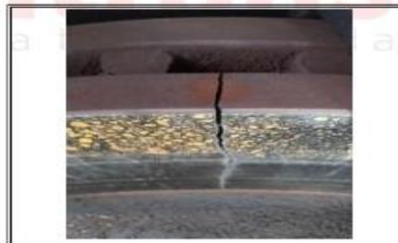
FRACTURA DISCOS DE FRENO POSICION 1
