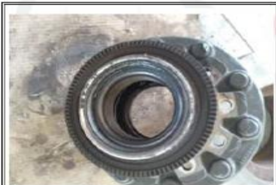
RETENEDORES DE CUBOS DE RUEDA DELANTEROS QUEMADOS POR ALTA TEMPERATURA
